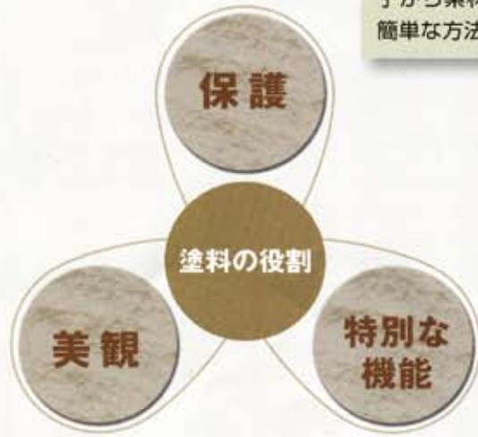
素材に塗料を塗ると、その表面に丈夫な塗膜をつくって環境因子から素材を保護します。定期的な塗替えや補修という比較的簡単な方法によって建築物などを長持ちさせることができます。
