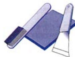
塗料を塗るもの自体が汚れていたり、傷んでいる場合は、上に塗料を塗っても下からはがれたり、凹凸ができてしまう。そうならないためにも予めよく洗浄し、それぞれの素材、状態に合わせて下地処理をする。下地処理とは、例えば木の場合はサンドペーパーをかけて表面のざらつきを取り滑らかにする、鉄に錆びがある場合は、ワイヤーブラシなどで取り除くなどの作業のことで、塗装の仕上がりに影響する大事な作業です。
